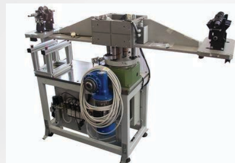
Sistema di asservimento automatico Struttura rotante con 2 pallet a 180°
